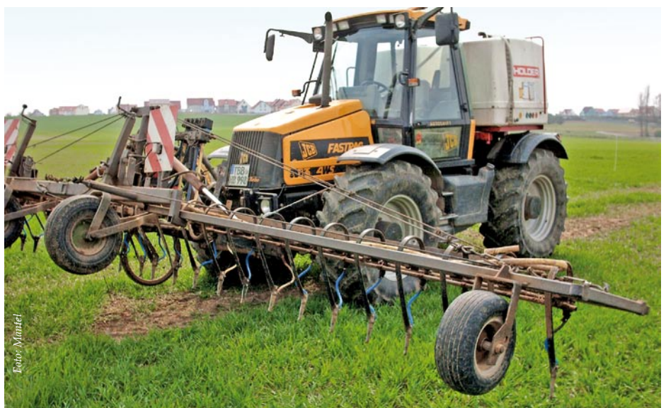
Bandförmige Düngerablage ist nicht optimal: Selbstbau aus Baden-Württemberg mit Schleppzinken.
