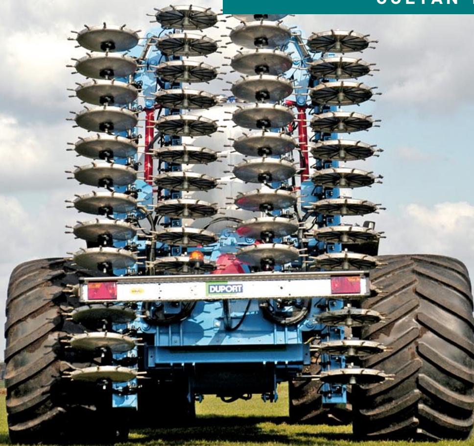
Duport Liquilizer mit 8.500 l Fassinhalt, 12 m Arbeitsbreite und Schiebearchse.
