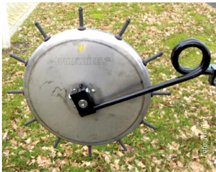
Flexibel abgefedertes Injektionsrad: weicht Steinen aus und hat eine optimale Boden Anpassung.
