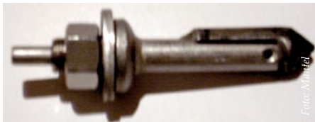
Spoke (Speichenstachel) mit durchgängigem Hartmetallpanzer und Nase als Schutz vor Verstopfungen.
