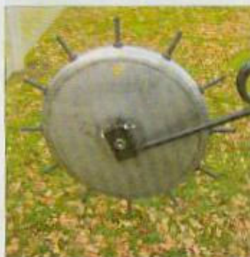
Per Injektionsrad kann in weitentwickelte Bestände gefahren werden.
